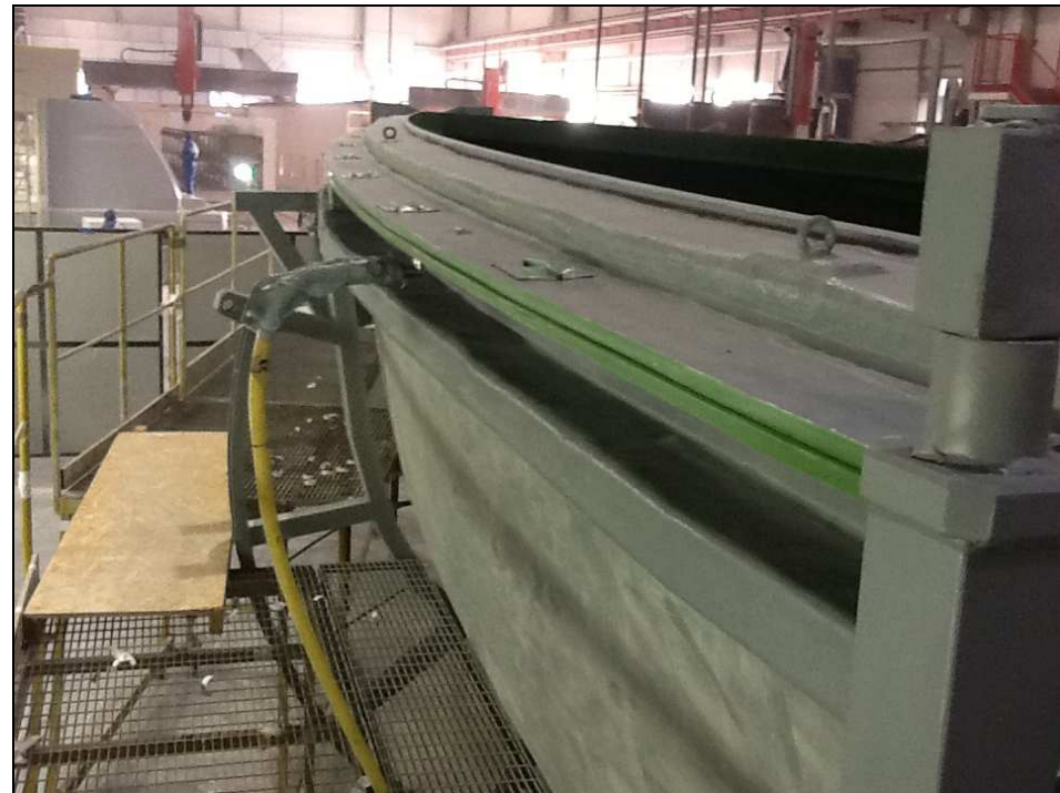
Stampo di una imbarcazione sottoposto a drop test
